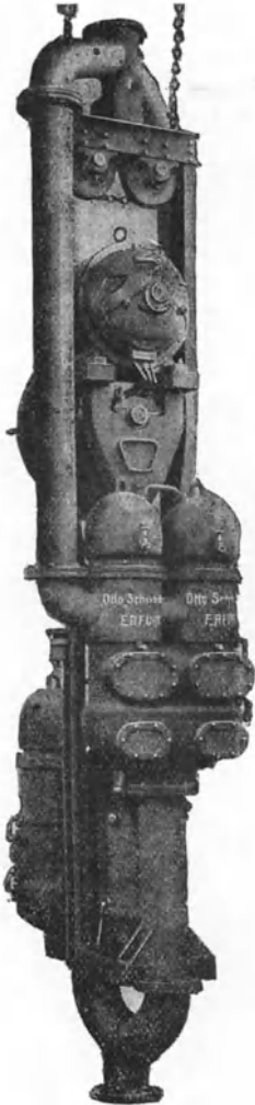
Fig. 327. Elektrisch angetriebene Kolbensenkpumpe von Otto Schwade & Co.
