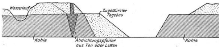
Fig. 31. Abhaltung des Oberflächenwassers von einem Tagebaue. (Braunkohle 1913, Fr. Müller.)
