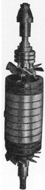
Fig. 333. Rotor mit Kühlung durch Windflügel der AEG.
